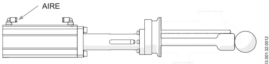
2. Posición de reposo: cuando el PIG está recogido en el interior del cuerpo del equipo.
