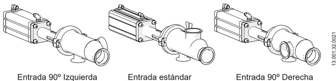
Además, tal como se muestra en la figura siguiente, las varillas guía del PIG deben quedar en un plano perpendicular al eje de la boca de entrada.
